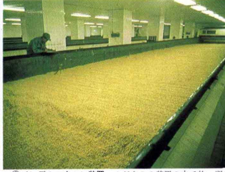
③バンデルハウヘン装置 ムギをこの装置の中で約一週間移動させながら発芽させる
