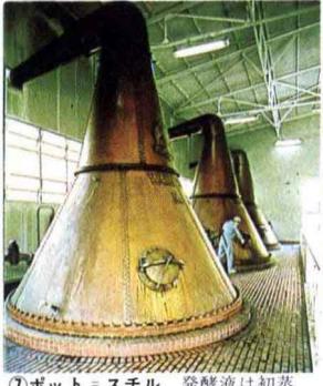
⑦ポット=スチル 発酵液は初蒸釜・再蒸釜と二回の蒸留作業をへて、酒精度の高い原酒となる
