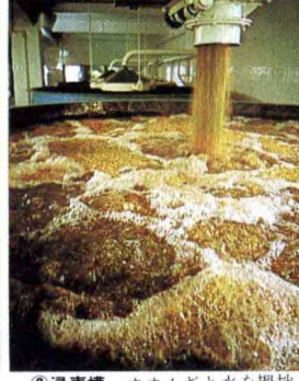
②浸麦槽 オオムギと水を攪拌し水分を吸収させて発芽を促す
