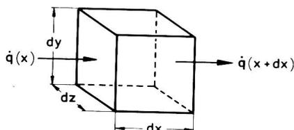
Bild 2/1: Element einer ebenen Wand
