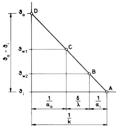
Bild 1/2: Graphische Ermittlung der Wandtemperaturen bei einer ebenen Wand
