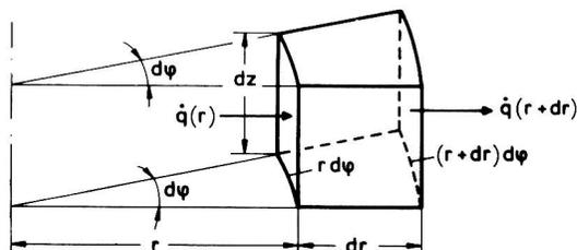
Bild 2/2: Element eines Zylinders
