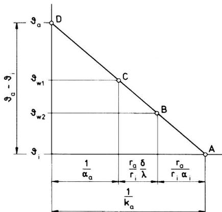
Bild 1/3: Graphische Ermittlung der Wandtemperaturen bei einer Rohrheizfläche
