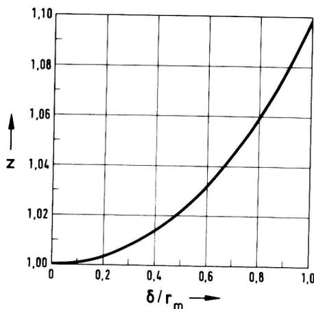
Bild 1/1: Korrekturfaktor  $z$  in Abhängigkeit vom Verhältnis der Wandstärke  $\delta$  zum mittleren Radius des Rohres  $r_m$
