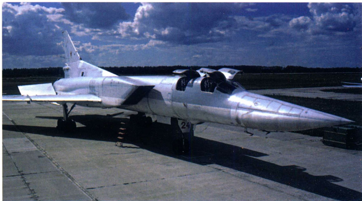
图-22M(Tu-22M) 苏联图波列夫设计局研制的双发涡扇可变后掠翼超声速重型轰炸机。早期编号图-26。北约集团给予绰号“逆火”(Backfire)。1969年8月首飞,1971年投产,生产总量约400架。有4名机组人员。两台NK-25涡轮风扇发动机,加力推力 2 \times 245 千牛。尾部炮塔装1门双管23毫米航炮(备弹800发),最大载弹量24000千克。机内最大载油量53000千克,最大平飞速度2000千米/小时,最大航程6300千米,作战半径2200千米,续航时间7小时。
