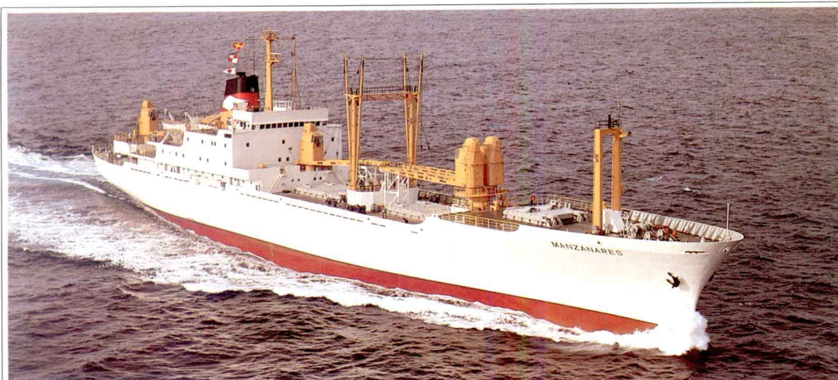
冷蔵・冷凍貨物船。貨物倉内の温度自動制御装置を備え、バナナ・冷凍魚・冷凍肉などあらゆる種類の生鮮冷凍貨物を積載できる
