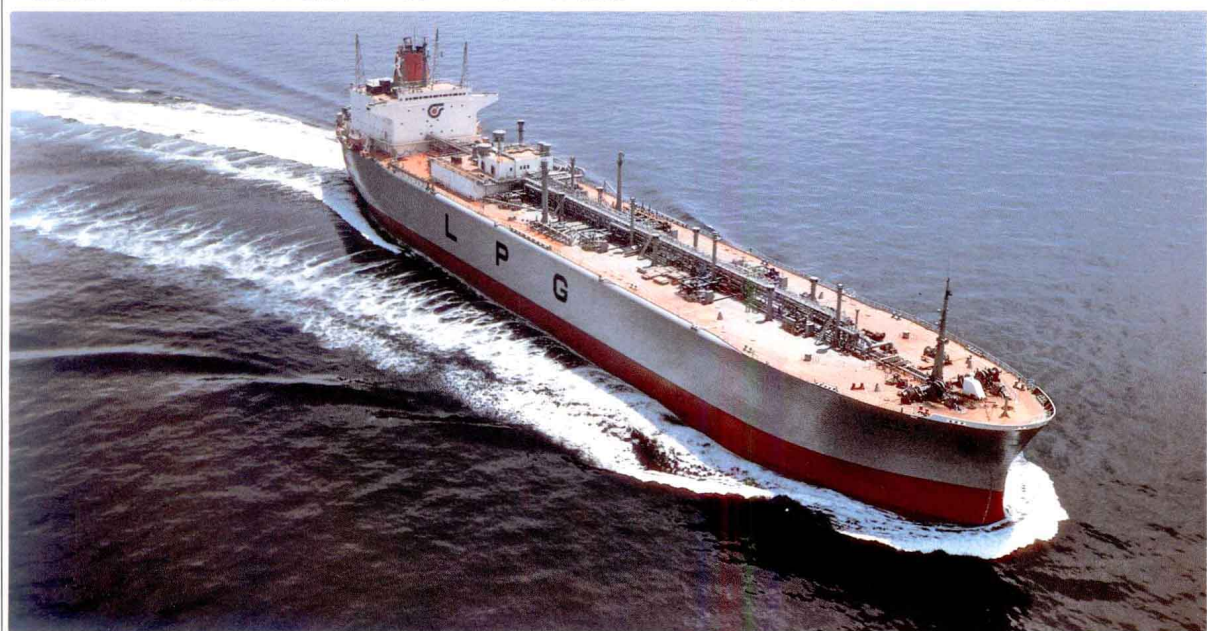
LPG運搬船。家庭用・業務用の燃料に使用される液化プロパンガスや液化ブタンガスを積載できる
