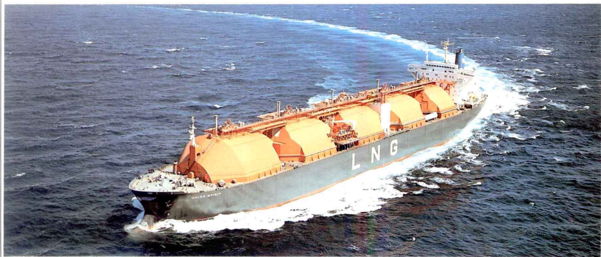
LNG運搬船。天然ガスを -162^{\circ}\text{C} という極低温で冷却液化して輸送するもので、5個の球型タンクを船体に搭載している
