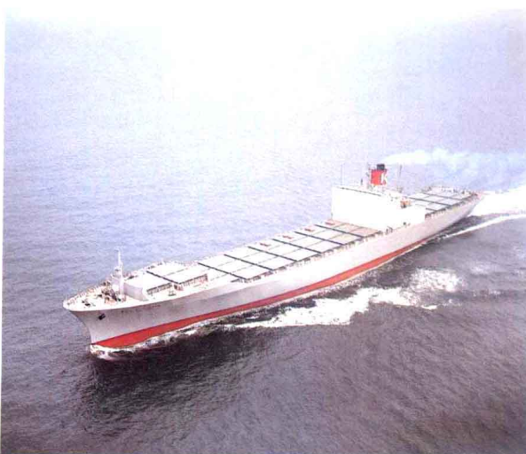
コンテナ船。荷役作業の方式によりローラーオン/オフ型(左)とリフトオン/オフ型(右)とがある。共に約2000個のコンテナを積載できる
