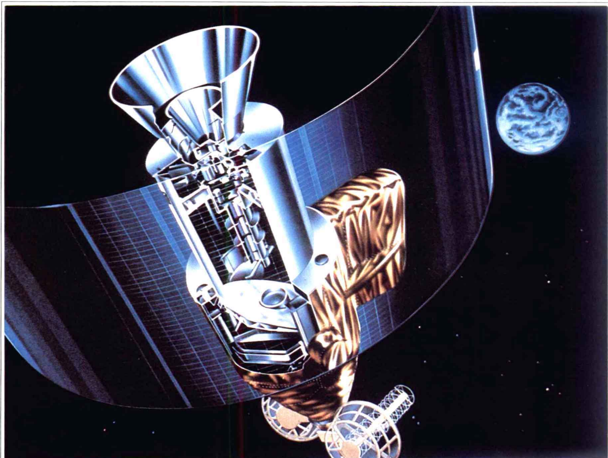
ひまわり2号の構造図。特に反射鏡やレンズ、センサーなどからなる可視・赤外走査放射計の断面をくわしく描いている
