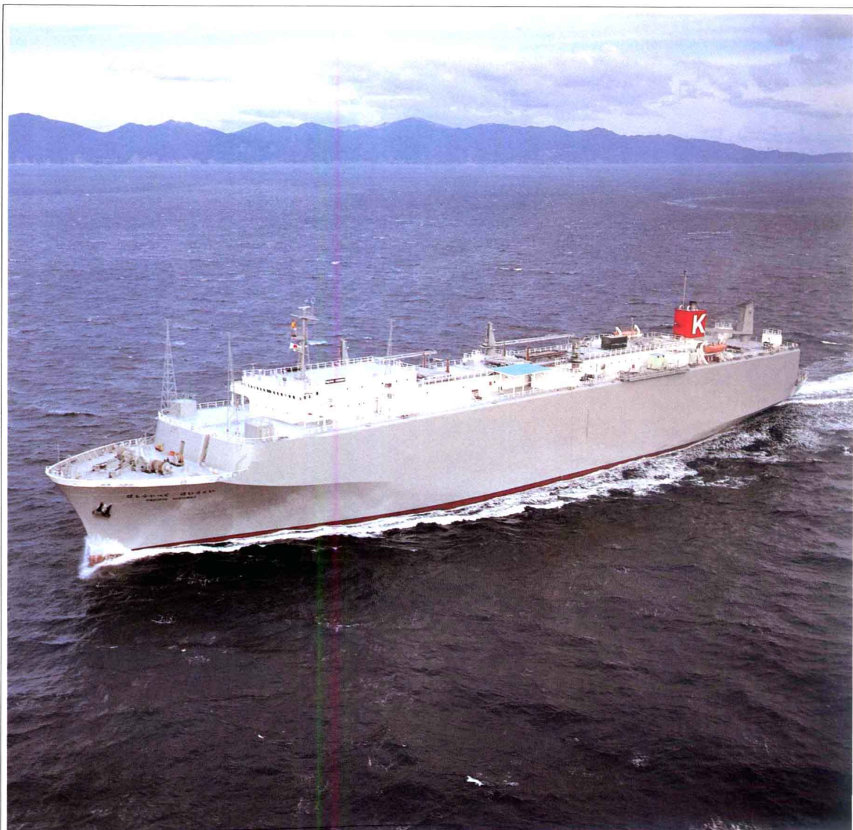
自動車運搬船。船倉に幾層もの甲板をもち、一度に2000台以上もの車を運ぶ。車は専用タラップを自力走行して積み込まれる
