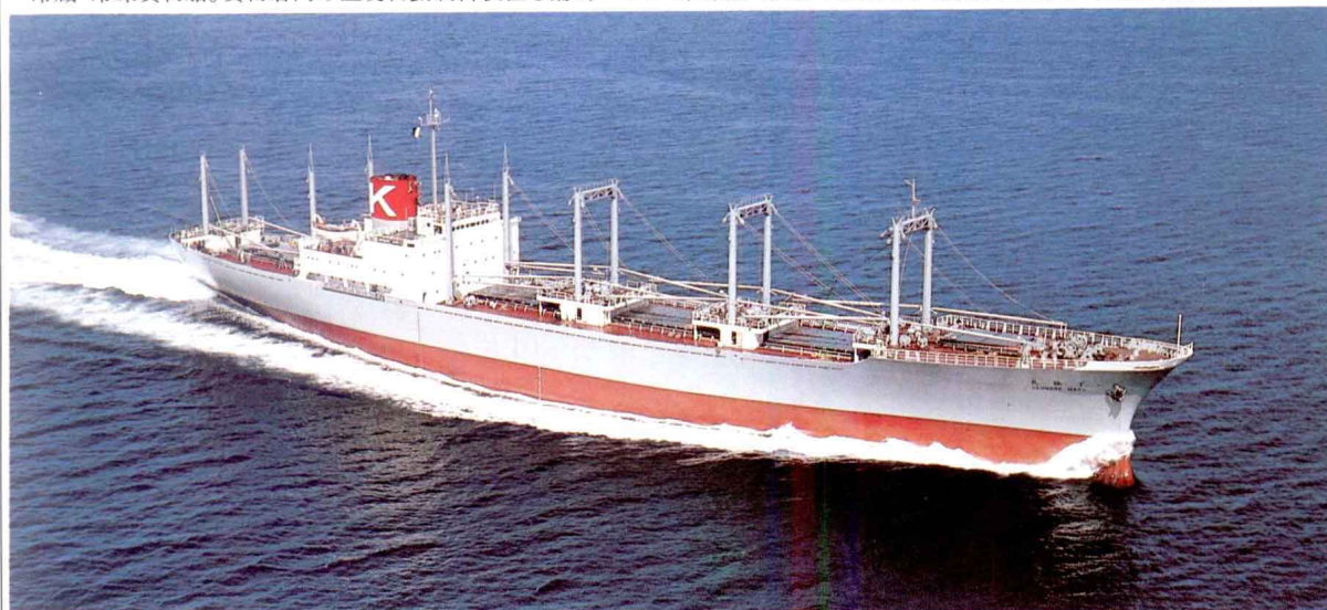
在来型雑貨船。雑貨を運ぶ一般貨物船のことで、コンピュータ利用などにより乗員の減少と高速化がはかられている
