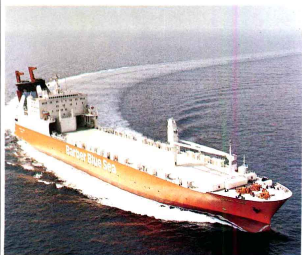
コンテナ船。荷役作業の方式によりローラーオン/オフ型(左)とリフトオン/オフ型(右)とがある。共に約2000個のコンテナを積載できる
