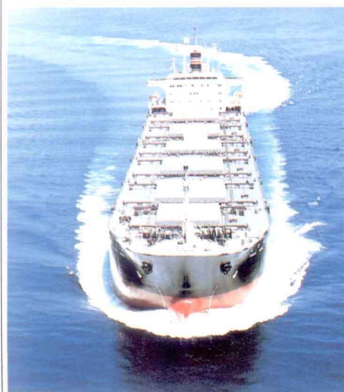
石炭運搬船。約7万トンの石炭を積載できる
