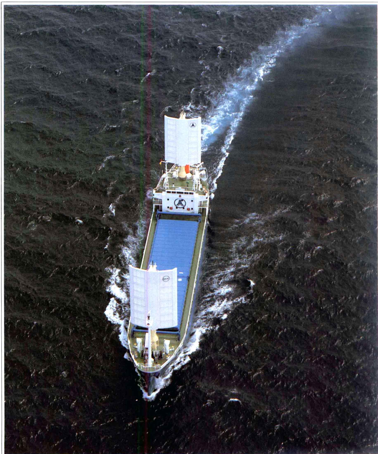
帆装貨物船。燃料を節約するために、マイクロコンピュータによる自動操帆の帆をもつ。安定性にも優れ、荒天にも揺れが少ない
