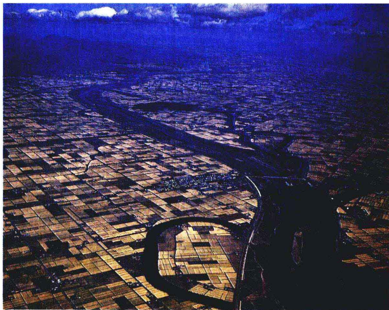
捷水路 石狩川、篠津一形町付近の捷水路。手前左側は蛇行していた昔の流路
