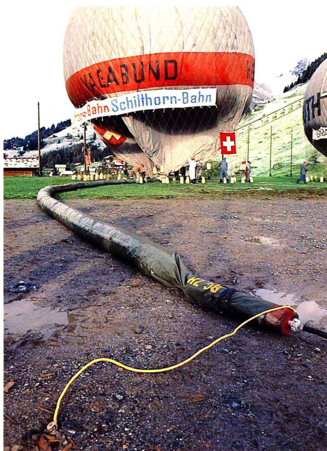
水素ガス注入中のバガブント号。パイプの金属部分には、アースをとって安全を期している。この大会に参加した気球のうち、最大級のもののひとつで、容積は2300 \text{m}^3 。水素の注入には4時間余りかかる。
