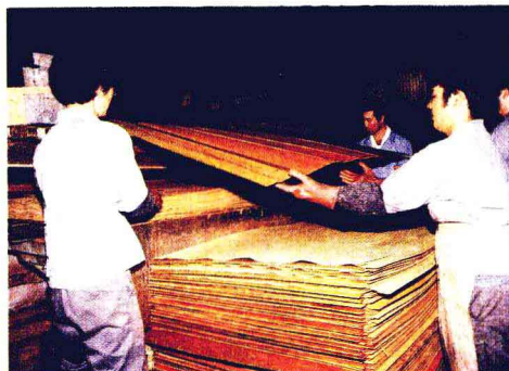
合板の製造 マレーシアやインドネシアから輸入された原木を年輪に沿って薄くはぎ、木目を交互に直交させ、接着剤で接着する。このあと、プレス機で圧縮成型される
