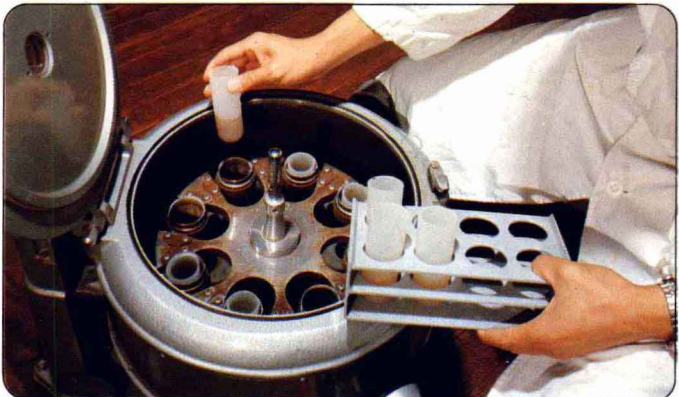
遠心分離 岩石や石炭を酸やアルカリで溶かし、溶け残った物から遠心分離機で花粉や胞子化石を取りだす。
