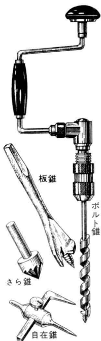
錐のいろいろ。上図は様子錐。上の丸い頭をからだにあて、ハンドルを回して使用する。左下はいずれも替刃
