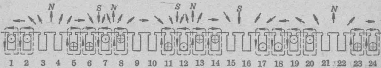
图 5 一相繞組中有一只綫圈接反 (7 至 11 槽中的綫圈)，
