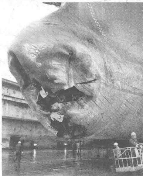
图 1.2 “Overseas Ohio”号遭遇冰山碰撞后的船舶损伤情形
