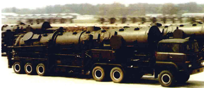
彩图 5 牵引 XX 型号中程导弹的 HY4260S 半挂牵引车
