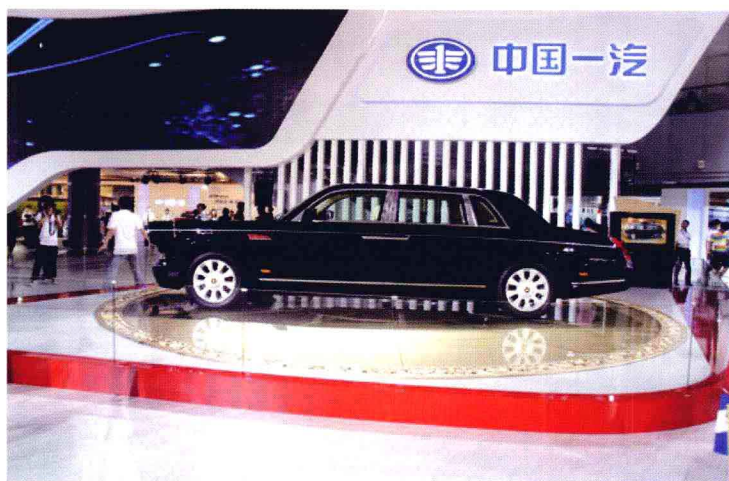
彩图 4 红旗元首级 HQE 高级轿车(V12 型发动机 排量 6.0 L)
