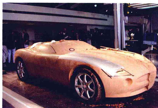
彩图 11 制作 1 : 1 外部模型(接近成型)
