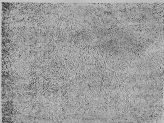
图2 I型缺陷—富铝6—4合金化学偏析
