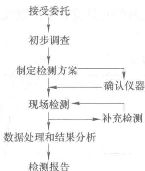
图 1-3 结构检测基本流程
