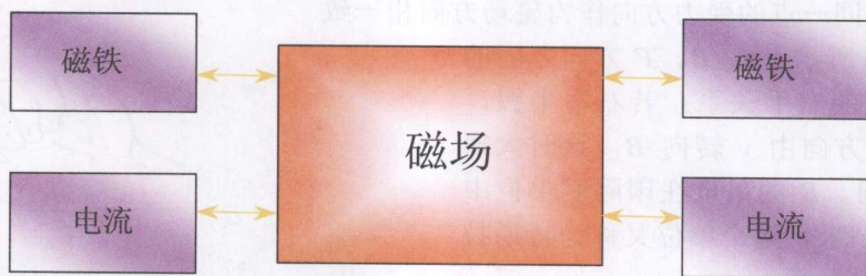
图 5-1-8 磁铁和磁铁、磁铁和电流以及电流和电流之间相互作用
