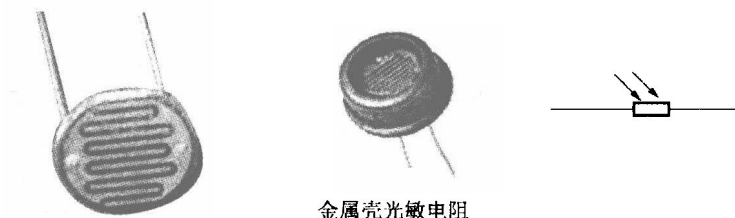
图 1.1—1 光敏电阻结构和符号
