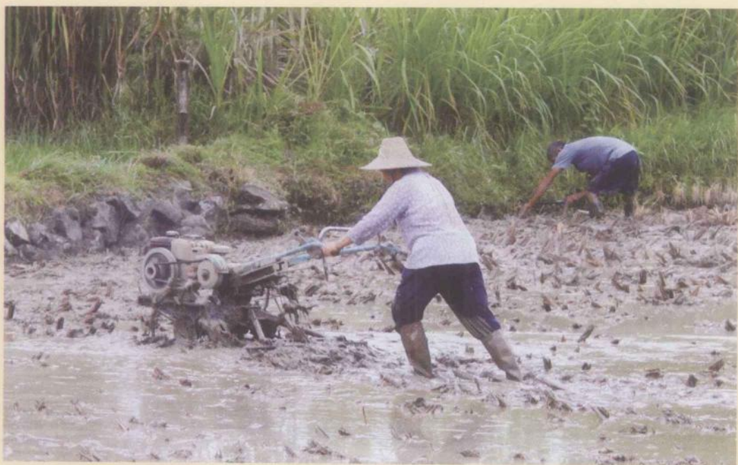
图12 小型农机具改变着山乡农民的生产方式，“小金牛”既可犁田又可运输
