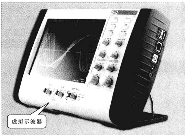
图 1-10 典型虚拟示波器的实物外形
