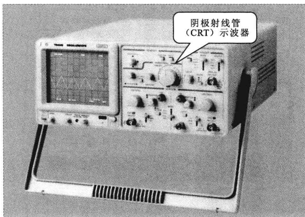
图 1-8 阴极射线管（CRT）示波器
