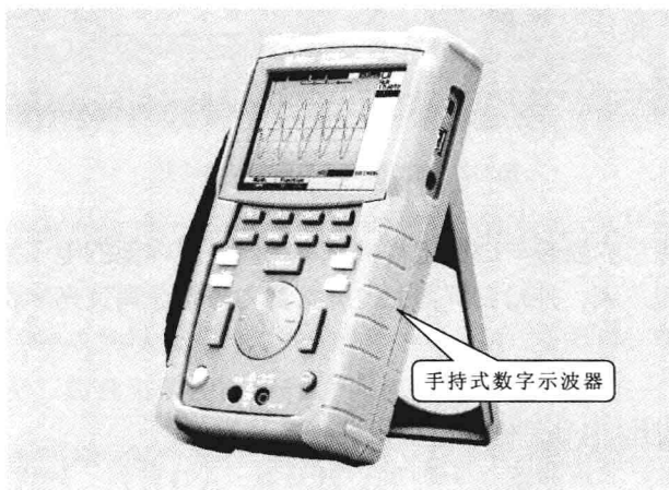
图 1-4 手持式数字存储示波器
