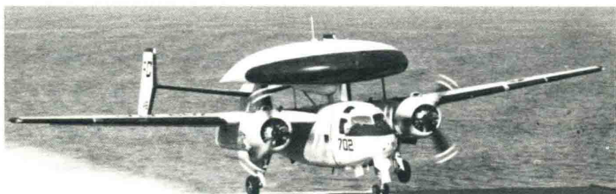
上图：格鲁曼公司的E-1B“追踪者”（美国海军内部称其为“Willy Fudd”或者“带有屋顶的Stoof”）。这张照片拍摄的时候，飞机正在航空母舰上进行短五边的着陆。注意被拉伸的停机钩。可以明显地看到巨大的雷达天线罩。
