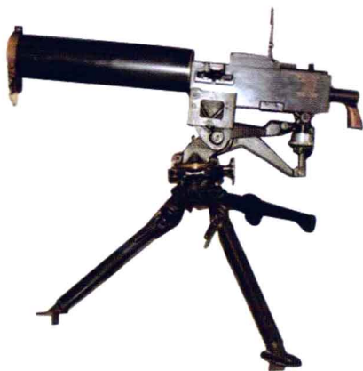
M1917A1 重机枪采用弹带供弹，利用枪机后坐能量带动拨弹机构运动。
