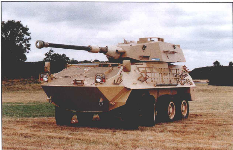
8 × 8 装甲车可用于执行多种任务以及加装各种武器系统，本图为装备 90 毫米火炮的莫瓦格公司锯脂鲤装甲车
