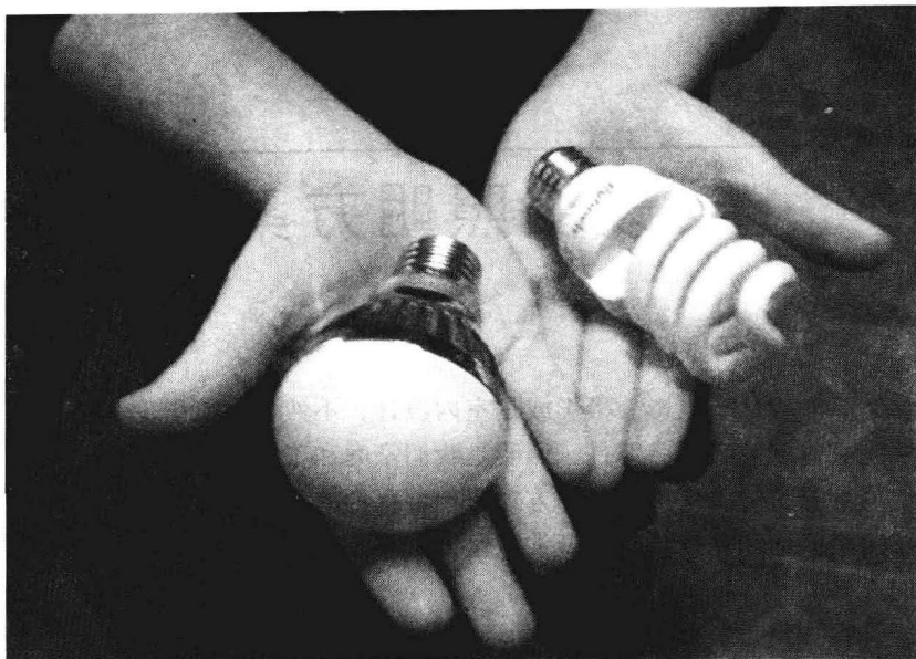
图 1-1 在绿色照明中，发光二极管（LED）灯（左）正逐步地代替紧凑型荧光灯（CFL）（右），因为前者的效率更高、寿命更长 （布莱恩·克拉克·霍华德拍摄）
