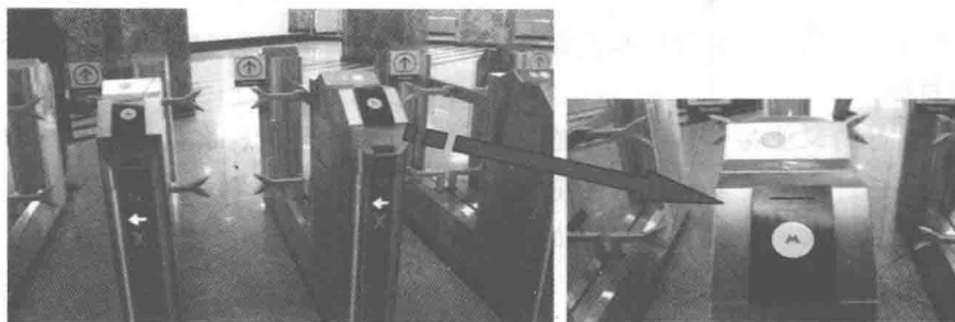
图1-2 莫斯科地铁检票闸机
