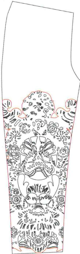
把衣服裁片扫描到电脑做成 1:1 的图，再把脸谱的图案做成镂空的线条格式，填充到 1:1 的裁片里，利用电脑激光烧花把脸谱图案变现在面料上。这个做法，可以让图案在裁片上的位置更精确，进行烧花时提高图案位置准确率。
