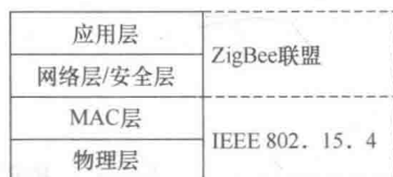
图 1.6 ZigBee 网络协议架构分层
