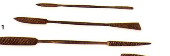
**锉刨和粗锉刀**锉刨 (2) 和粗锉刀 (3) 可赋予石膏、木料或加气混凝土砌块以粗略的形态和造型。由刀身所残留的印象，可以用作装饰性的表面质感。
