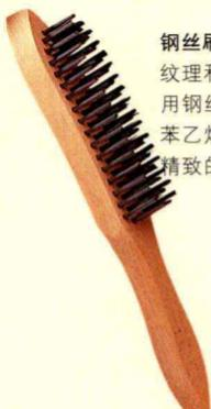
**钢丝刷**在木雕品中用来开掘纹理和剔除雕刻残余物。使用钢丝刷既能形成膨胀的聚苯乙烯泡沫塑料，也可营造精致的细部。
