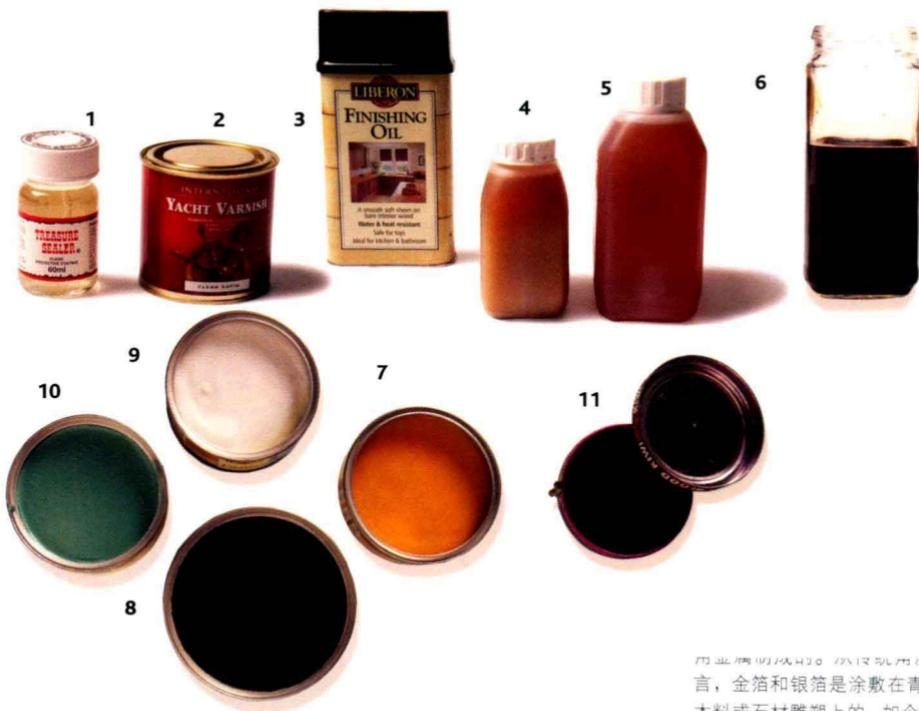
**微妙莫测的饰面封闭底漆 (1)、清漆 (2) 和饰面处理油 (3)** 呈透明或近乎透明的涂层，可形成带光泽、半光泽或无光泽的饰面。它们在木料上用得极为频繁，但是也可以用来保护钢材不至于生锈。白色磨光漆 (4) 和法国磨漆 (5) 呈固态或液态。两者涂敷到表面上，经过干燥，然后用布或刷子擦拭以形成平滑、发光的表面。准备置于户外的木质雕塑，需要用化学防腐剂，以获得抵御风吹雨淋和腐烂的保护。这些防腐剂是作为家庭或篱笆着色剂而供应的，既有透明的，也可提供一系列不同的色彩，包括天然木料的色泽 (6)。蜂蜡 (7) 可以按天然状态使用，虽然它通
