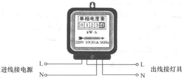
图 1-11 电度表接线图
