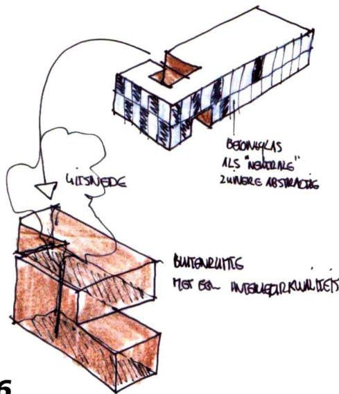
该建筑的外立面为一座简洁的长方形单体，其外立面采用相同规格的混凝土和玻璃嵌板交错覆盖。因此，从外观上看，该建筑不同于一般的工业建筑，建筑师从外形和材质上将建筑的办公区和生产区区分开。这种设计使建筑显得十分庄重，并与工业区的其他建筑区别开来，同时能强化业主对于开发者和建设者身份的认同。建筑侧面的区域和入口处的设计进一步强化了这一属性。此外，建筑还配有庭院和屋顶平台。庭院的营造可使自然光线直射建筑中心区域，为业主提供私密空间和安静的工作氛围。
