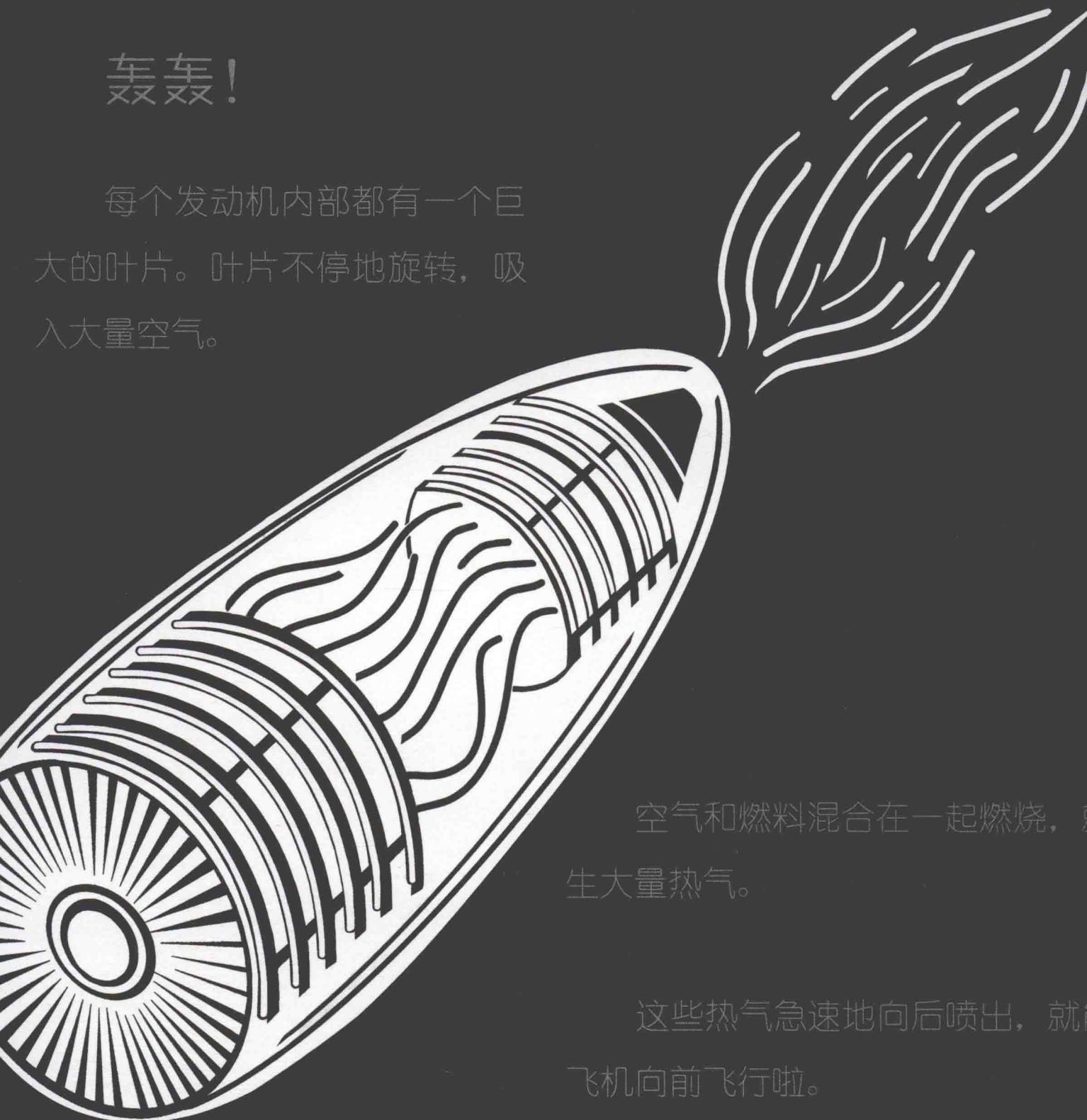
空气和燃料混合在一起燃烧，就会产生大量热气。
