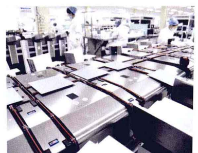
光伏硅片自动化生产线
