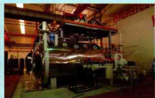
动态混料真空压力浇注设备-干式变压器、电抗器等
