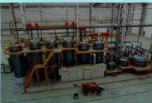
真空干燥带浸油设备-高压套管干燥浸油
