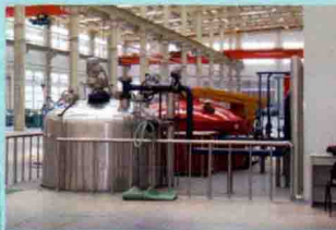
真空压力浸渍设备-干变、干式电抗器、电机等产品
