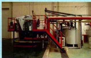
静态混料真空浇注设备-高压干式套管超导线圈等
