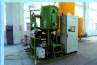
真空滤油机110-1000KV电压等级的绝缘油
