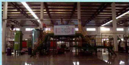
大型环氧树脂预混料生产线-大批量生产环氧和固化剂的预混料
