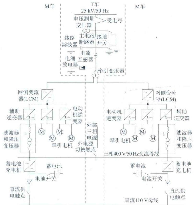
辅助变流器将牵引变流器的中间直流电压DC 3 000 V变换成为三相AC 440 V/60 Hz，向列车交流干线并联供电，车载电源箱内装有小变压器，将三相AC 440 V/60 Hz中的2相线电压降压为230 V/60 Hz单相交流电，向本车的供热等交流负载供电。每辆车上有一个单相逆变器将DC 110 V逆变成220 V/50 Hz单相交流电，给本车客室插座等供电。CRH3型动车组辅助供电系统构成如图5—1—3所示。
