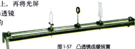
图 1-57 凸透镜成像装置
