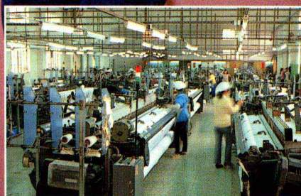
大進紡織廠擁有意大利劍杆機紡織先進設備， 生產各類色織布料
