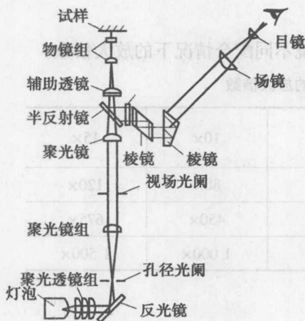
图 1.2 XJB-1 型金相显微镜光学系统示意图
