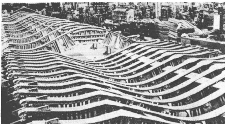
■ 生产车间里等待装配的主翼梁，从F4U-1-7型，这种翼梁结构始终未变过。
