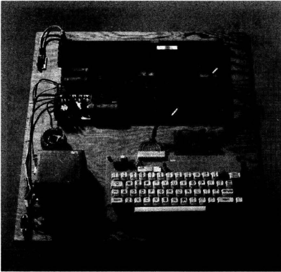
沃兹设计出一款可以连上网络打字并即时回传字符显示到电视屏幕上的终端机。
