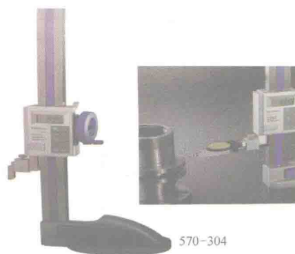
24. 用高度仪 + 杠杆表检验圆台高度误差
