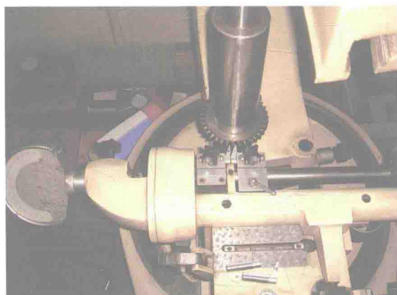
38. 用万能测齿仪测量齿距总误差 F_p
