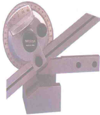
6. 用游标万能角度尺测量燕尾槽及斜面角度
