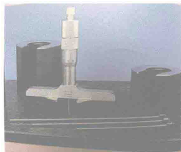
28. 用接杆式千分尺精测高度
