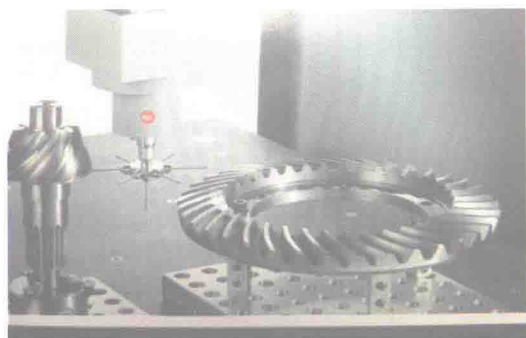
59. 测量准双曲面齿轮参数
