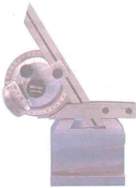
6. 用游标万能角度尺测量燕尾槽及斜面角度
