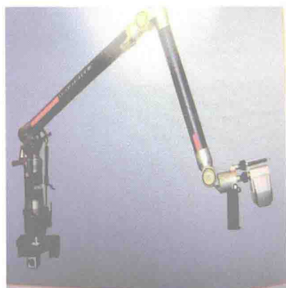
63. 专为激光扫描非接触测头设计的关节臂
