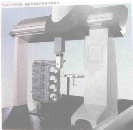
57. 三坐标测量机对箱体工件的测量
