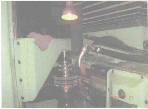
42. 滚齿机加工, 需经工件安装、机床调整、切齿对刀、首件检测合格后进行
