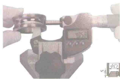
26. 用球面测砧心轴型千分尺测轴承沟槽壁厚
