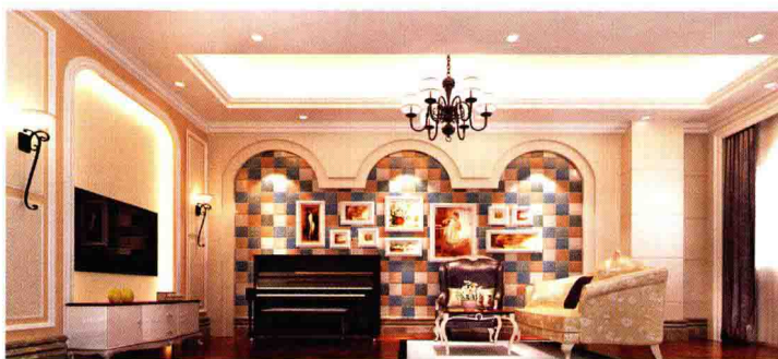
居中墙 [ 多色仿古砖混铺 + 石膏板造型 ]
