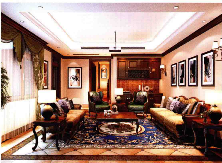
地面 [ 仿古砖夹小花砖斜铺 + 花砖波打线 ]
