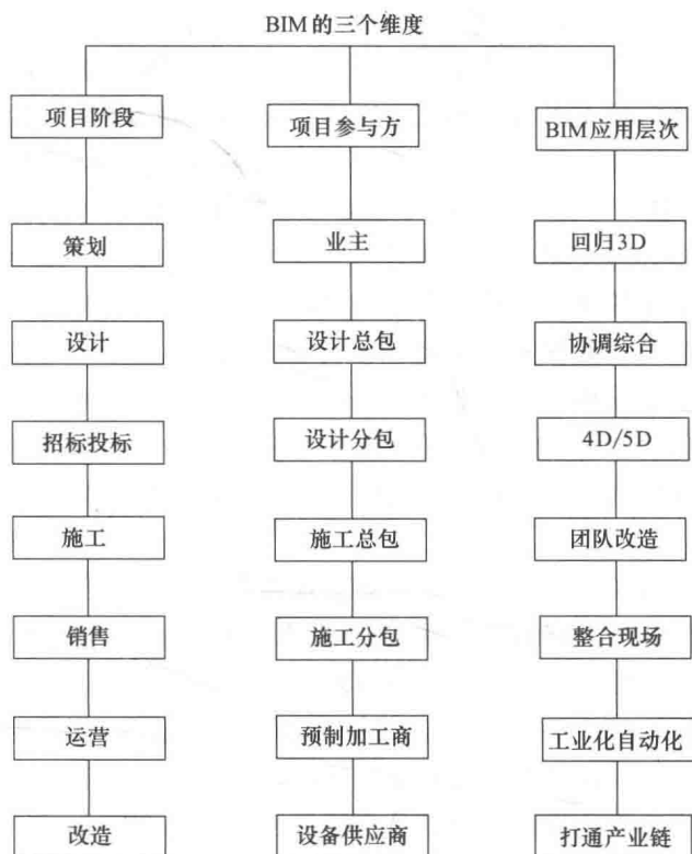
图 1.2 BIM 的三个维度
