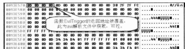
图 6 拷贝结束后堆栈内存状态
