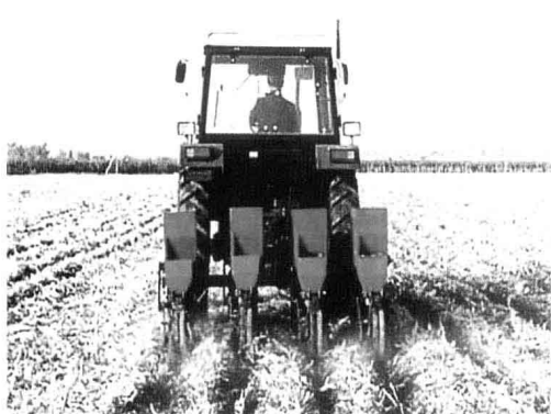
玉米免耕播种机在玉米碎秆覆盖地免耕播种玉米
