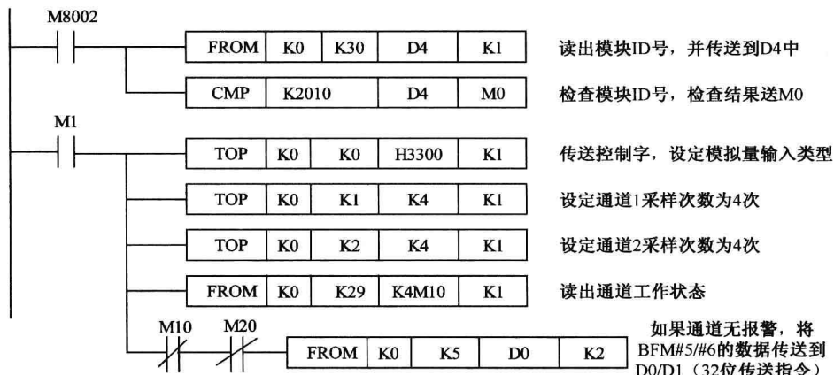
图 1-4 FX 2N -4AD 编程实例
