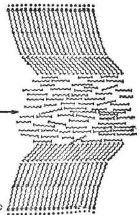
圖10 潤滑材料的分子和物體表面關係的圖解。
