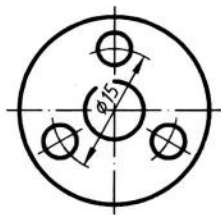
图 1-12 尺寸数字断开各类图线
