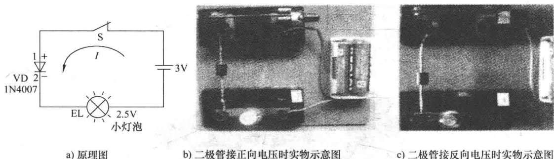
图 1-5 二极管导电性实验
