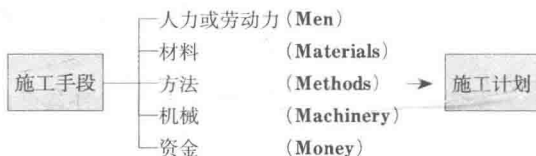
图 1.1 施工手段和施工计划
