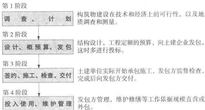
图 1.5 土建施工的4个阶段
