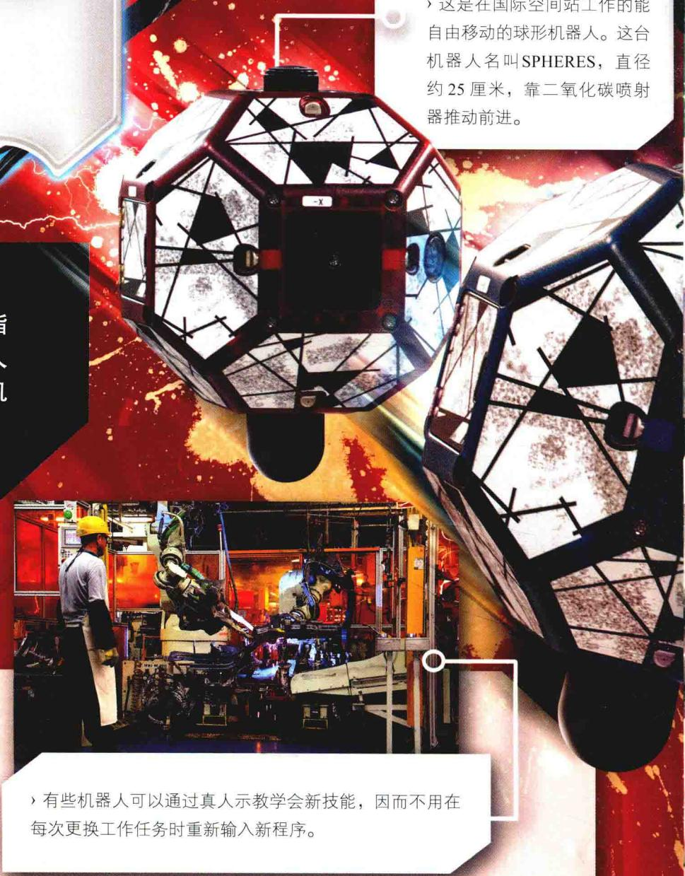
这是在国际空间站工作的能自由移动的球形机器人。这台机器人名叫SPHERES，直径约25厘米，靠二氧化碳喷射器推动前进。
