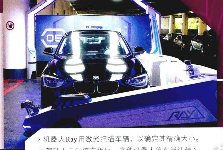
机器人Ray用激光扫描车辆，以确定其精确大小。与驾驶人自行停车相比，这种机器人停车能让停车场容量增加60%。
