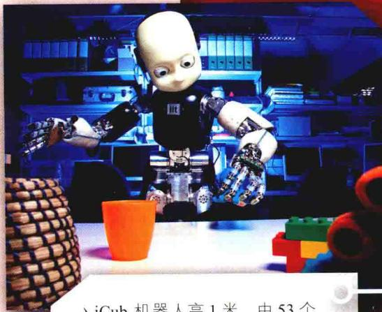
iCub 机器人高 1 米，由 53 个电机为它的身体各部位提供动力。它已经通过了许多艰难的测试，包括成功闯关 3D 迷宫。
