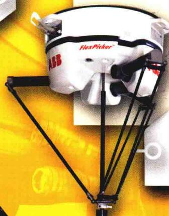
› ABB 公司的机器人 IRB 340 FlexPicker 正在飞快地拾取、检验传送带上的食品。它每分钟可以拾取 400 件产品。
