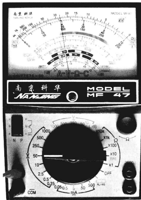
图 1-7 笔记本电源适配器输出的电压值
