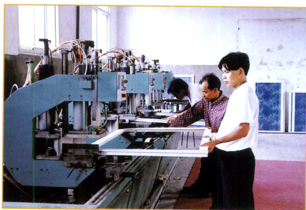
绥阳县华辉化学建材有限公司塑钢门窗组装车间
